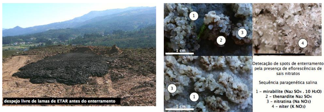
Figura 13 Ilustração do despejo de lamas de ETAR e detecção dos locais do seu enterramento pela presença de eflorescências de sais nitratos.
