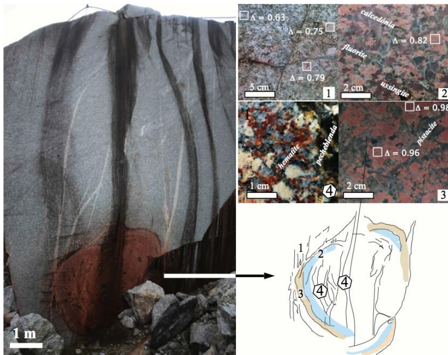
Figura 25 Localização estruturada de alguns minerais indicadores de anomalia radiométrica. Ocorrência da Pedreira de Casas de Monforte, Chaves, Trás-os-Montes. Nota: os algarismos 1 a 4 indicam os locais onde se colheram as amostras cuja triclinicidade \Delta foi determinada.
